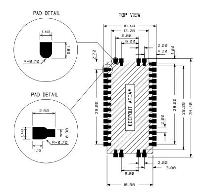
\* NO COPPER AND TRACKS UNDER THE MODULE
